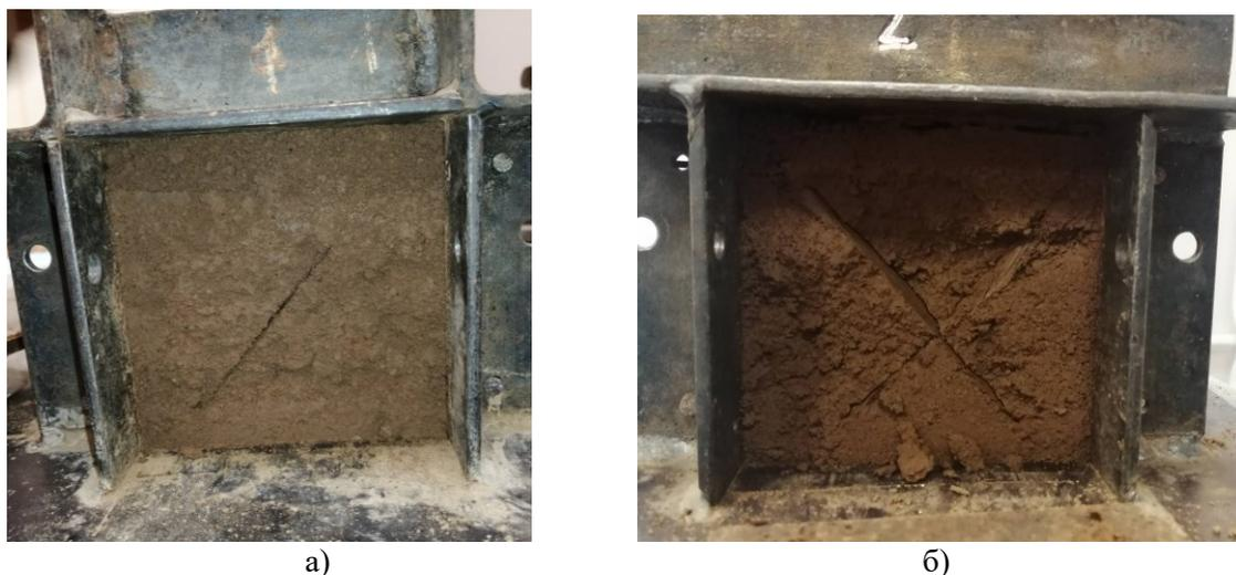
Рис. 1. Образцы с трещинами в плоскостях равновесия: а) с одной трещиной; б) с двумя пересекающимися трещинами в двух плоскостях равновесия (иллюстрации авторов)
